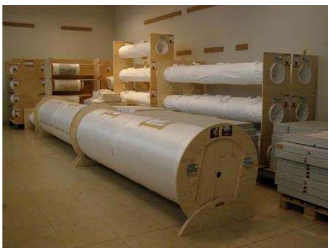
Ill 30. Objektide õige pakendamine ja boiustamine aitavad kaasa tapeetide pikaajalisele säilimisele. Suuremõtmelisi seinakatteid, sealhulgas tapeete, on kõige optimaalsem säilitada suurtel puidust või papist silindritel.
